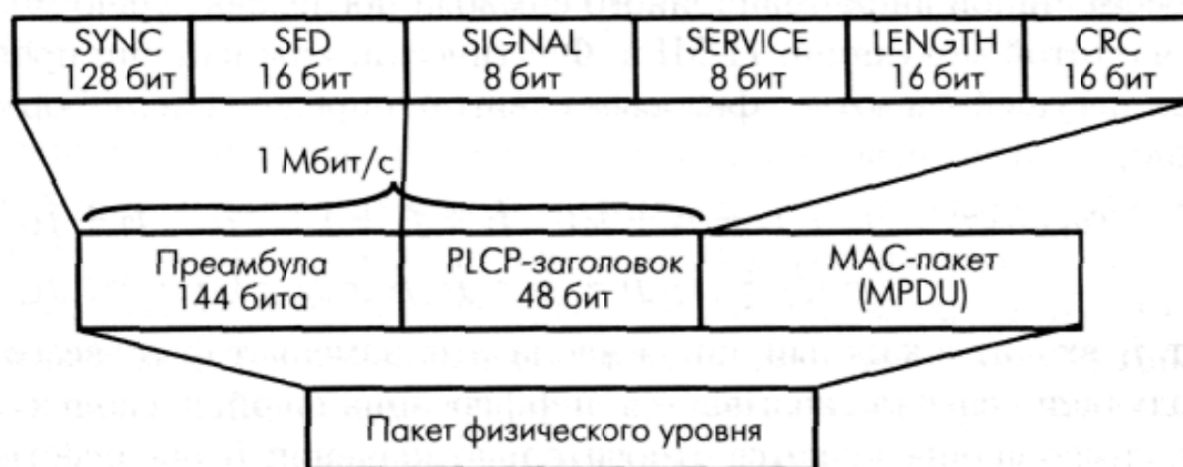
Рис. 1.25 Структура кадров сети IEEE 802.11b физического уровня
