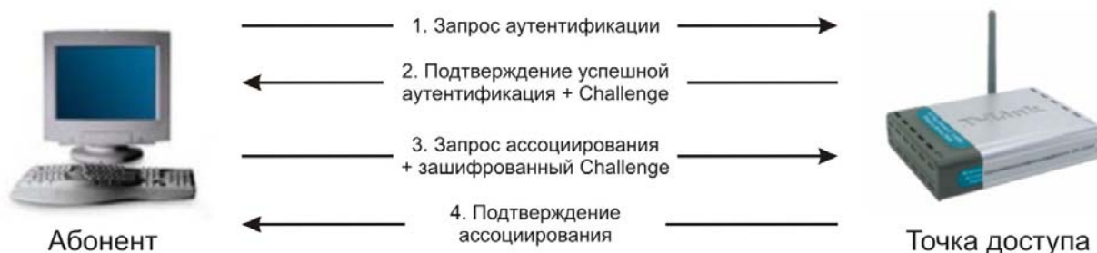
Рис. 2.20 Аутентификация с общим ключом
