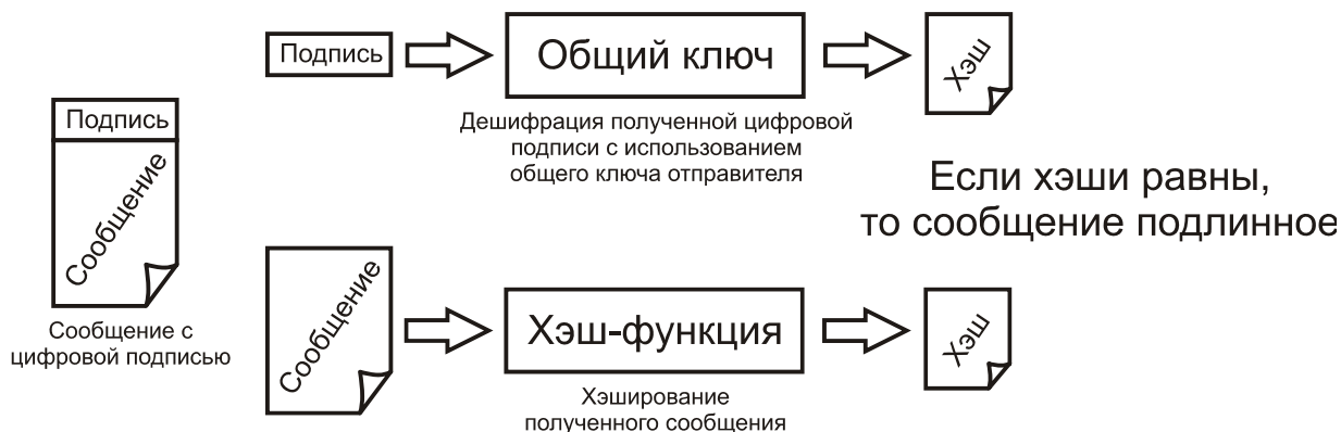
Рис. 2.8 Проверка подлинности сообщения с цифровой подписью
