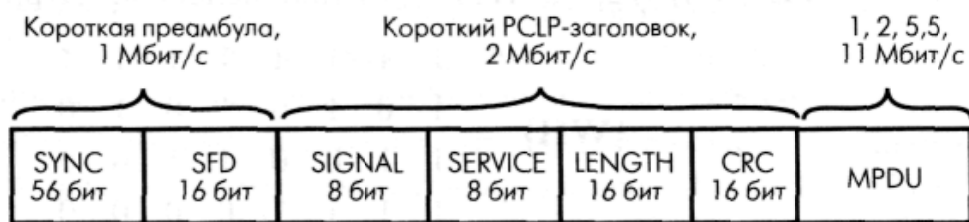
Рис. 1.26. Короткий заголовок кадров сети 802.11b
